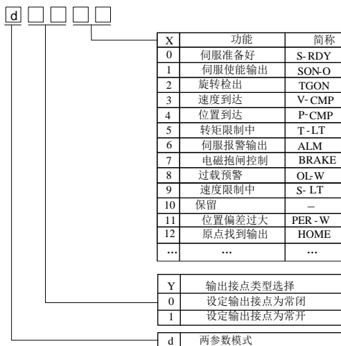
图 8.1.2 可编程输出端子功能设定示意图
